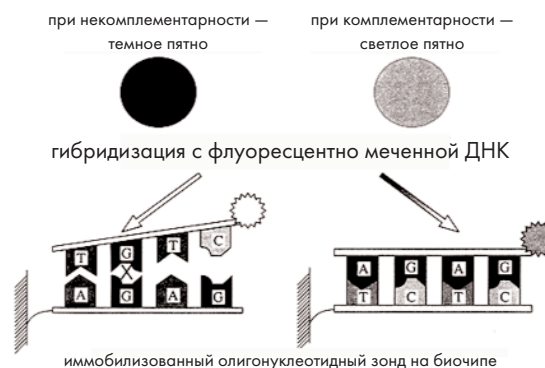
Рисунок 7. Схема образования двойной спирали ДНК на биочипе.
